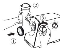
**2** Вставьте в головку мясорубки шнек длинным концом вперед, слегка поворачивая его, пока он не встанет в нужное положение в корпусе.
