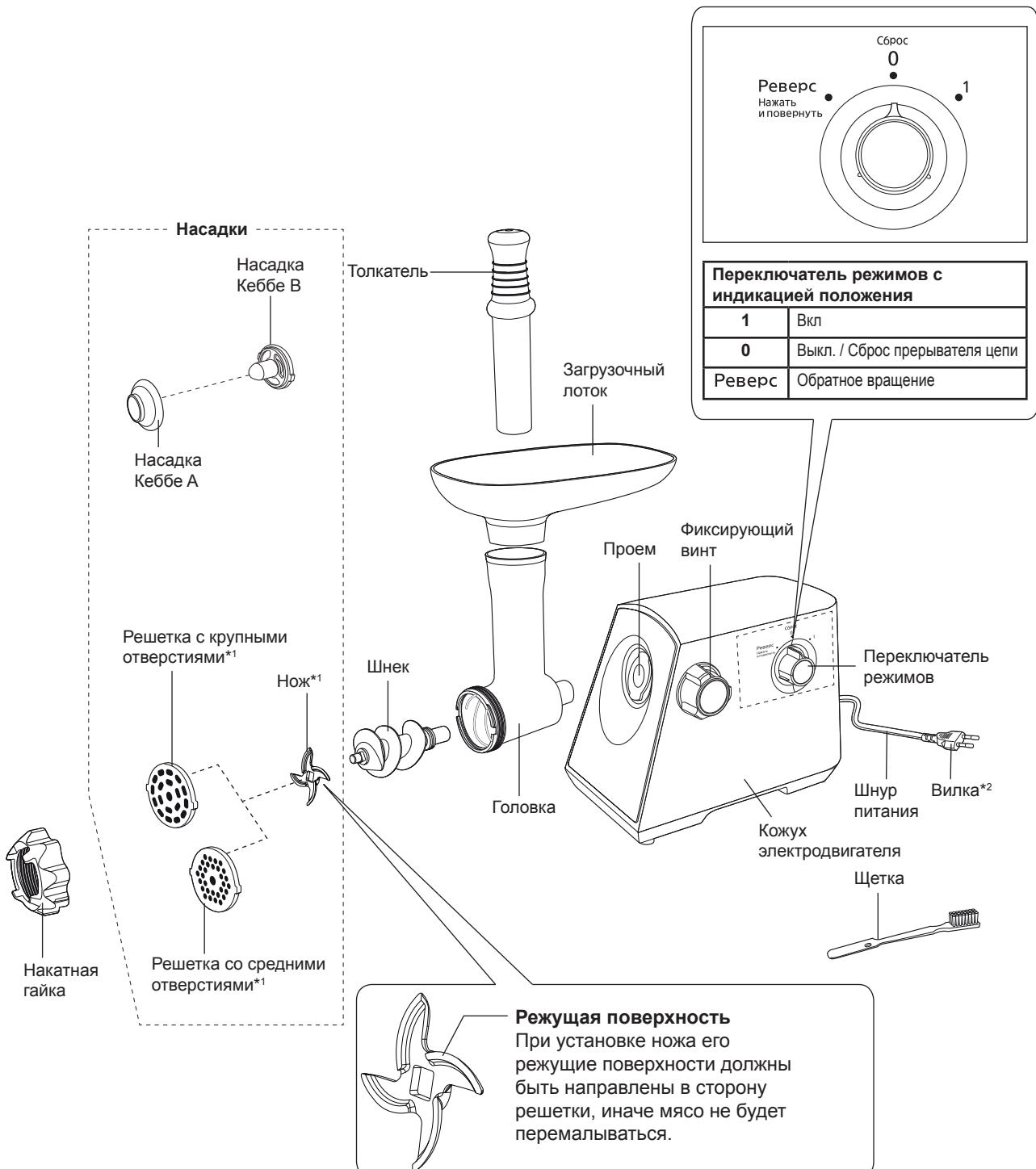
\*¹ Режущий блок состоит из ножа и решеток с отверстиями.
