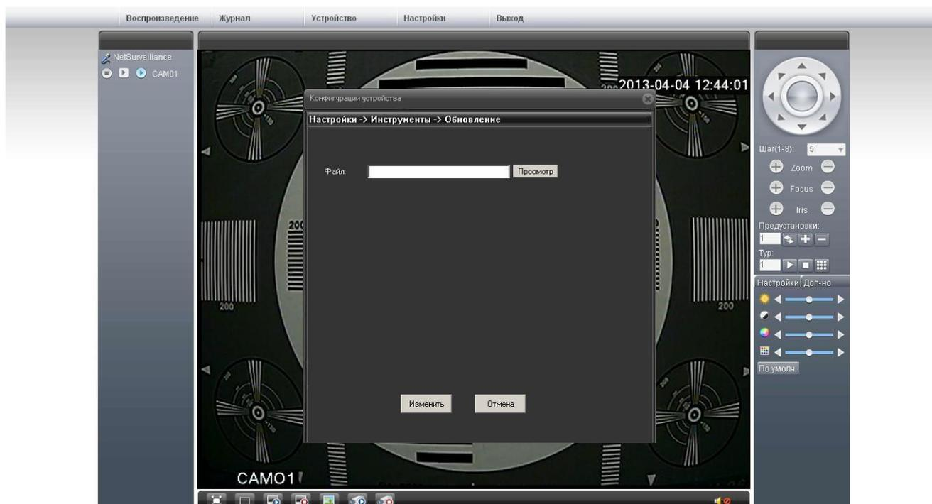
Раздел позволяет осуществить обновление прошивки камеры.
