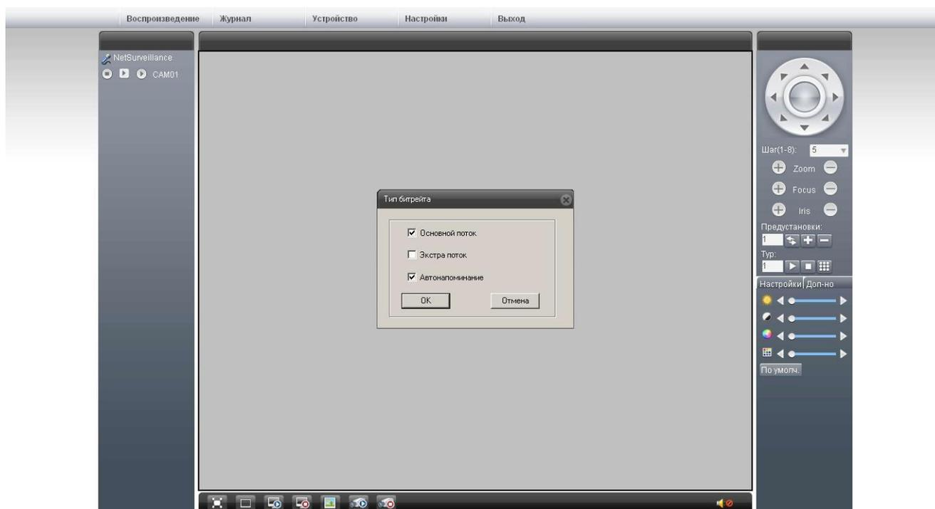
Запуск WEB-интерфейса камеры сопровождается появлением окна «Тип битрейта», позволяющим настроить режим отображения видео потока
