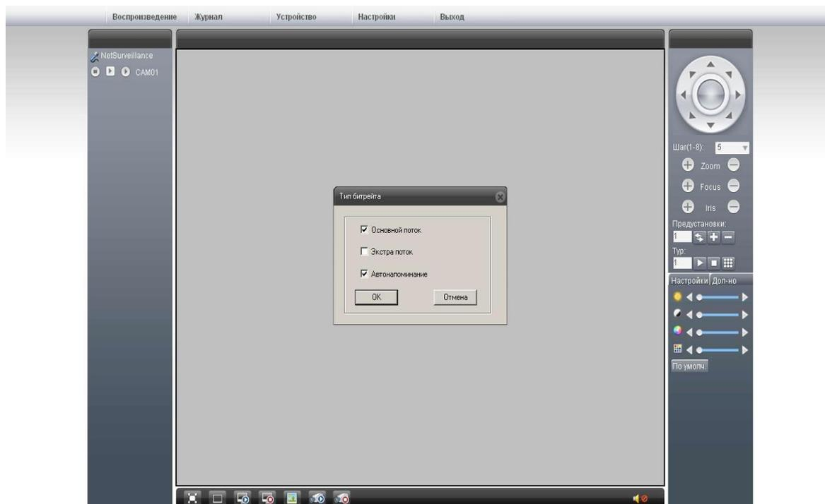
Запуск WEB-интерфейса камеры сопровождается появлением окна «Тип битрейда», позволяющим настроить режим отображения видео потока
