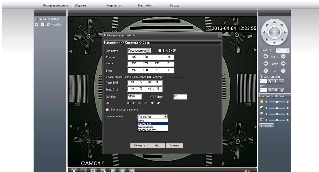
Раздел позволяет настроить параметры камеры для возможности доступа на неё из различных мест. Параметры возможно задать вручную, либо автоматически, включив DHCP (функция DHCP предварительно должна быть настроена).
