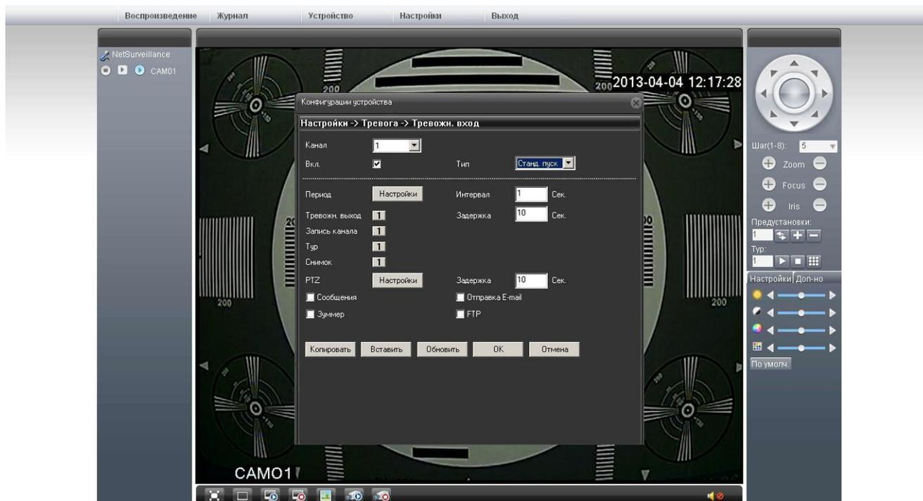
Раздел позволяет настроить действие камеры по сработке датчика, подключенного к тревожному входу.
