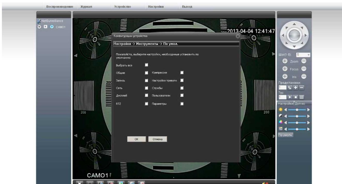
Раздел позволяет сбросить настройки камеры на заводские. Возможно сбросить как все настройки, так и выбрать, какой раздел будет сброшен.
