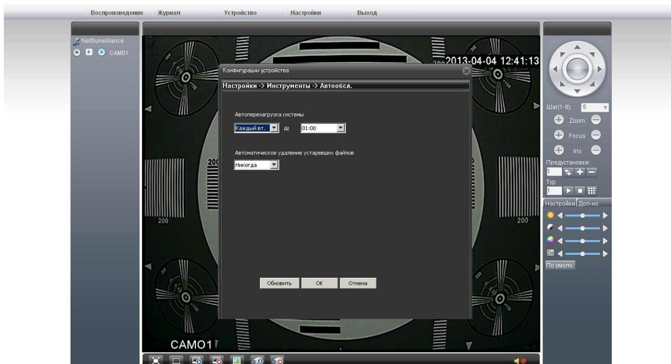
Раздел позволяет настроить время автоматической перезагрузки камеры, а также время удаления устаревших видеофайлов, сделанных камерой.
