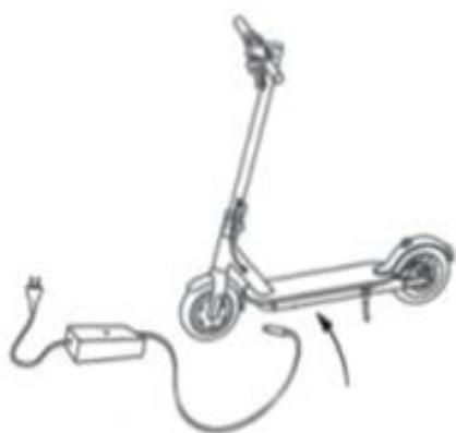
Перед первым использованием самоката полностью зарядите аккумулятор. Откройте резиновую крышку зарядного порта в нижней части самоката и вставьте выходной разъем зарядного устройства в зарядный порт. Вставьте вилку в розетку. Если индикатор зарядного устройства красный, это означает, что аккумулятор заряжается. Если он становится зеленым, это означает, что
