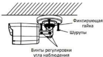
Рисунок 2-2 Установка камеры на потолок
