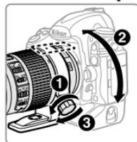
Ослабьте ручку установки (1), поставьте указатели положения в нужную вертикальную или горизонтальную ориентацию (2), а затем затяните ручку установки (3).
