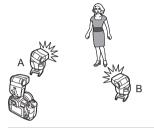
Устройствам-приемникам можно назначать группы вспышек А и В, относительную мощность каждой из которых можно регулировать. Экспозиция регулируется автоматически так, чтобы общая мощность групп обеспечивала стандартную экспозицию.
