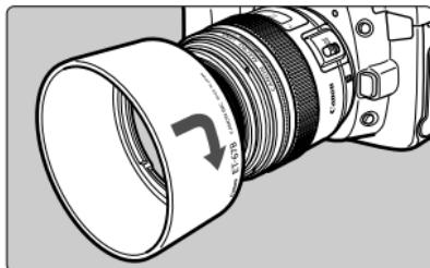
Подсоедините и выровняйте бленду на креплении бленды в передней части объектива, затем поверните бленду, как это указано стрелкой, чтобы надежно закрепить ее. При хранении объектива можно закрепить бленду на объективе в обратной ориентации.
