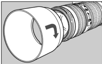
Бленда ET-74 не допускает нежелательные блики и свет на линзы объектива, а также защищает объектив от попадания на поверхность линзы дождя, снега и пыли. Подсоедините и выровняйте бленду на креплении бленды в передней части объектива, затем поверните бленду, как это указано стрелкой, чтобы надежно закрепить ее. При хранении объектива можно закрепить бленду на объективе в обратной ориентации.
