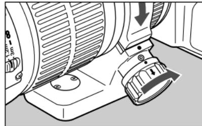
**3** Чтобы смонтировать штативную пятку на объективе, оттягивая наружу винт замка, верните воротник в изначальное положение и надежно затяните винт замка.
