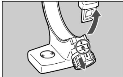
**1** Поверните винт замка против часовой стрелки, чтобы его ослабить (около 3 оборотов), затем потяните винт в направлении, указанном стрелкой, чтобы расцепить воротник штативной пятки.
