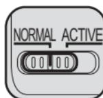
**NORMAL**: 减震装置主要减少相机震动的影响。水平和垂直摇镜拍摄时也会减少相机震动的影响。
