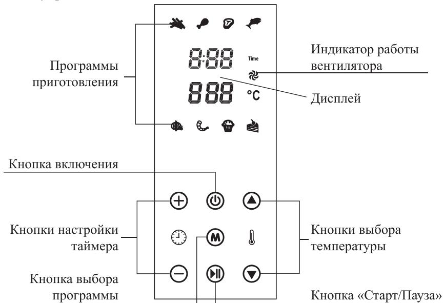
На дисплее отображается время приготовления, температура и выбранная программа.
