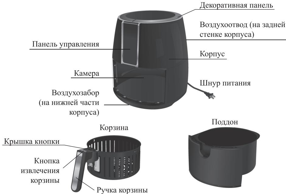
Принцип работы аэрогриля основан на конвекции воздушных потоков от нагревателя внутри рабочей емкости. Вентилятор, расположенный в верхней части аэрогриля, приводит в движение воздушные массы, нагретые до высокой температуры ТЭНом (трубчатый электронагреватель). Горячий воздух циркулирует внутри рабочей емкости аэрогриля и нагревает продукты до нужной кондиции.
