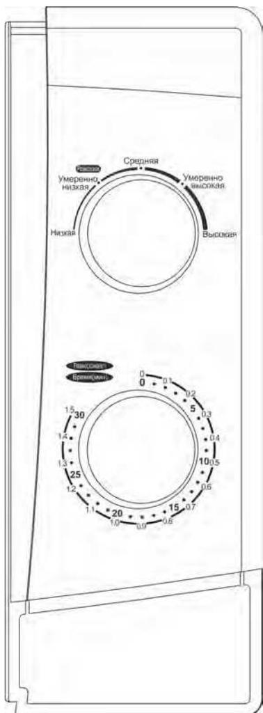
Панель управления состоит из двух функциональных переключателей. Одним из них является ручка регулирования времени приготовления (Таймер), а другой регулятор мощности.
