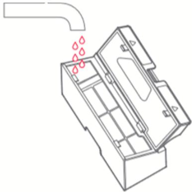
2. Промойте пылесборник, наполнив его водой и встряхнув
