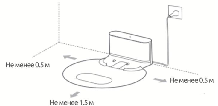
Поместите зарядную док-станцию к стене на ровном полу и вставьте ее в розетку. Спрячьте лишний кабель внутри.
