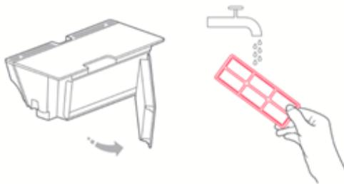
3. Промойте фильтр проточной водой
