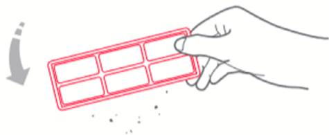
4. Несколько раз промойте и слегка постучите рамой фильтра по твердой поверхности, чтобы стряхнуть грязь. Продолжайте, пока не очистите.
