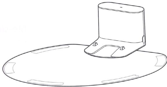
Поместите зарядную док-станцию к стене на ровном полу и вставьте ее в розетку. Спрячьте лишний кабель внутри.
