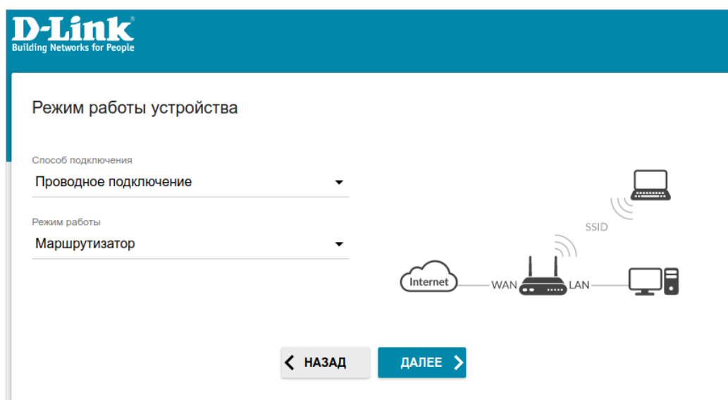
Рисунок 33. Выбор режима работы устройства. Режим Маршрутизатор .
