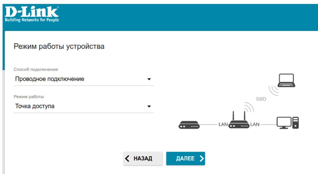
Рисунок 35. Выбор режима работы устройства. Режим Точка доступа .
