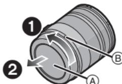
**2 Alignez les repères pour la mise en place de l'objectif (Ⓑ) (marques rouges) sur le boîtier de l'appareil photo et sur l'objectif, puis tournez l'objectif dans le sens de la flèche jusqu'à ce que vous entendiez un déclic.**
