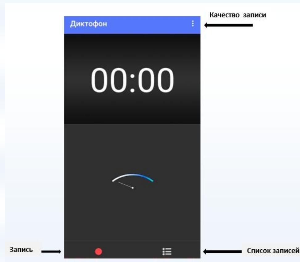
Для осуществления записи нажмите клавишу *Запись*. Для постановки записи на паузу нажмите клавишу *Пауза*. Для продолжения записи вновь нажмите клавишу *Запись*. Для остановки записи звукового файла нажмите клавишу *Стоп*. Затем нажмите сенсорную клавишу *Сохранить* для сохранения записи или *Отменить*, чтобы отменить сохранение.
